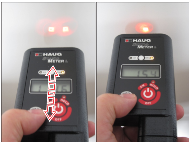
Abb. 2: Einstellen des korrekten Abstands
