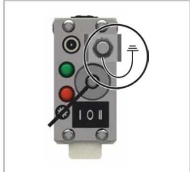
5. Eine Spannungsversorgung (12 – 24 V<sub>DC</sub>) an das Ionisationsgerät anschließen. Es stehen 2 Möglichkeiten zur Verfügung.
